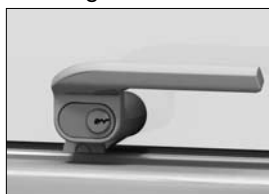
Paskvilgreb til cylinderlås. OBS: kan i skydedøre kun monteres i lukkesiden pga. grebets dybde.
